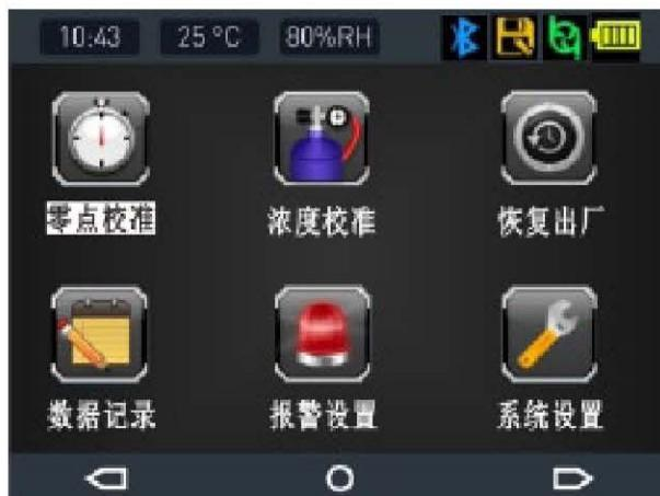
选择要校准的通道，按“OK”键进行零点校准，校准成功以后显示：“校准成功”字样，如下图：
