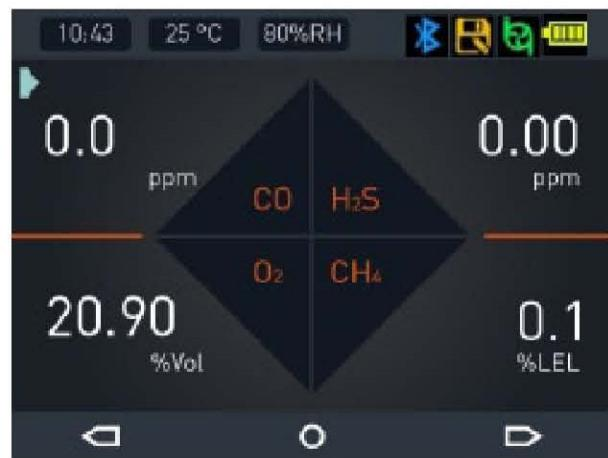
按确认键“OK键”可切换不同的显示模式，按»»键切换通道。各种模式都有图片指示（图片与实际产品有偏差，建议图片参考实物），如下图：
