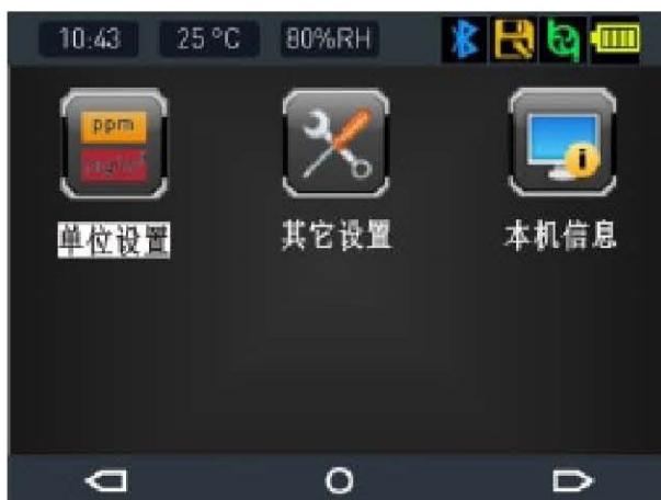
各单位之间自动换算，可以切换的单位：ppm、Vol%、LEL%、ppb、pphm、mg/m<sup>3</sup>、mg/L、g/m<sup>3</sup>，如下图：
