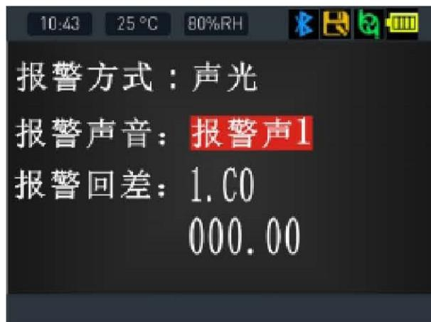
**报警回差：**即报警回程差，可设置每一通道的报警回差值，如果设置为0，只要数值达到报警设定值就马上报警，若不想数值在报警设定值的临界点发生频繁报警，可以把报警回差设置一定的数值，通过“OK”键和“◀”键和“▶”键修改，如右图：
