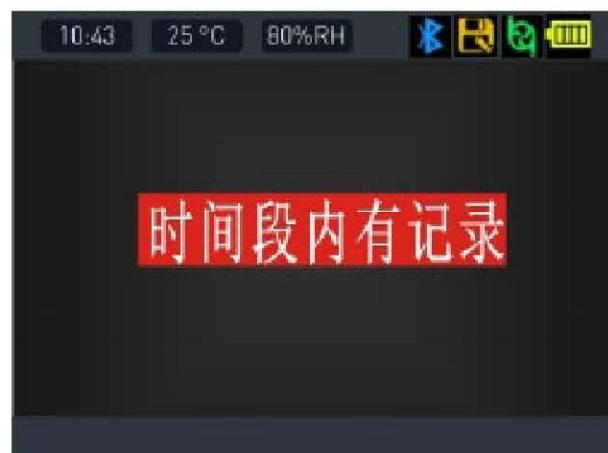
请前往“系统设置”→“存储设置”确认存储功能是否开启。选择“定时存储”即实时存储功能并设置存储周期（时间间隔）。
